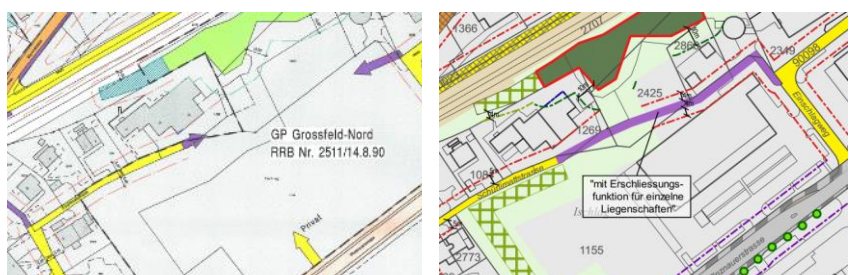
Abbildung 64.: Fuss- und Radwegverbindung Grossfeld Nord
